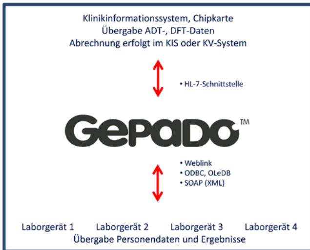
Abb. 4 ◀ Darstellung der Kommunikation von GEPADO mit Fremdsystemen unter Nutzung des Kommunikationsservers Transconnect.
